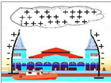
Figura: Descarga atmosférica sobre os Para-raios do mercado de ferro (Fonte: stock.adobe - Adaptado)
