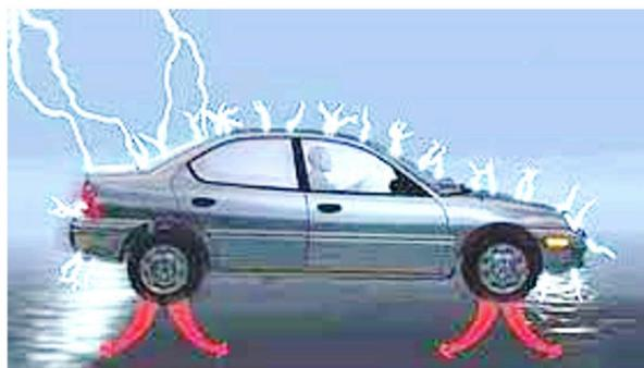
Figura: Descarga atmosférica distribuída na blindagem do carro
