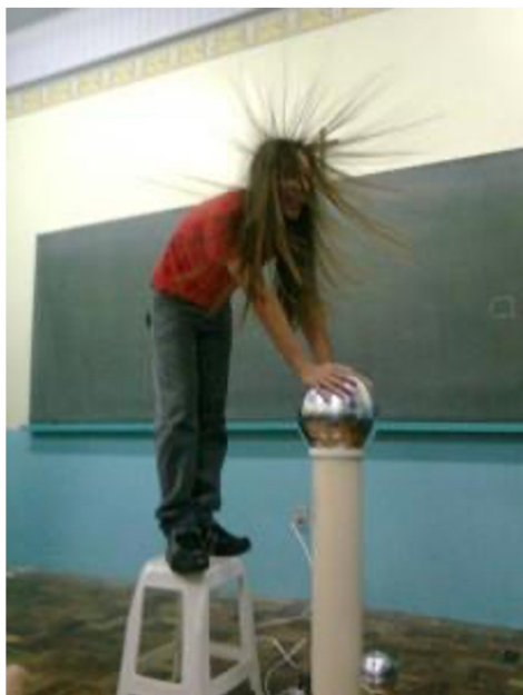
Figura: Gerador de Van de Graaff e o famoso efeito de arrepiar os cabelos. Para que isso aconteça, a pessoa deve estar isolada da superfície da Terra, caso contrário ela leva um choque (fonte: pir2.forumeiros.com)
