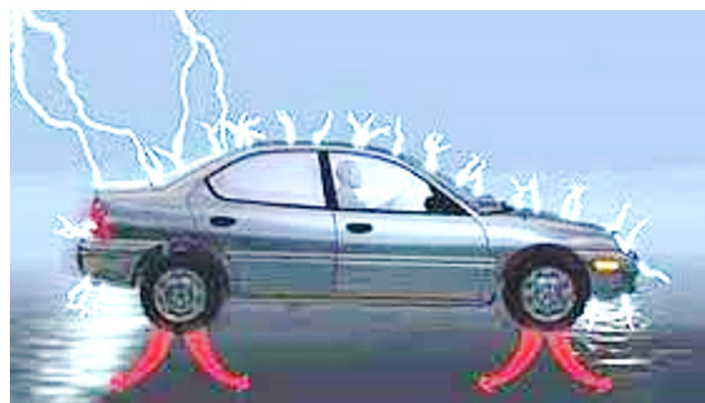
Figura: Descarga atmosférica distribuída na blindagem do carro (Fonte: Físicanossa)
